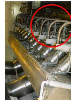
12-cylindres Sulzer RTA84C avec 66 120 bhp (48 600 kW) pour des navires porte-conteneur
